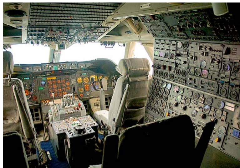
Das Cockpit einer B747. Rechts befindet sich der Arbeitsplatz des Flugingenieurs. Foto: Air France
